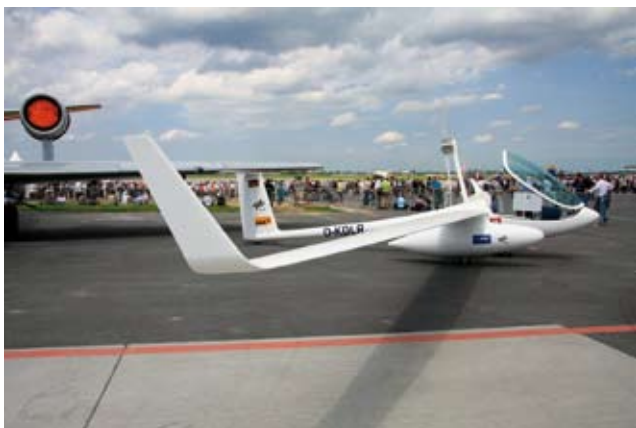
Der Antares 20E der DLR mit Wasserstofftanks unter der Tragfläche.
