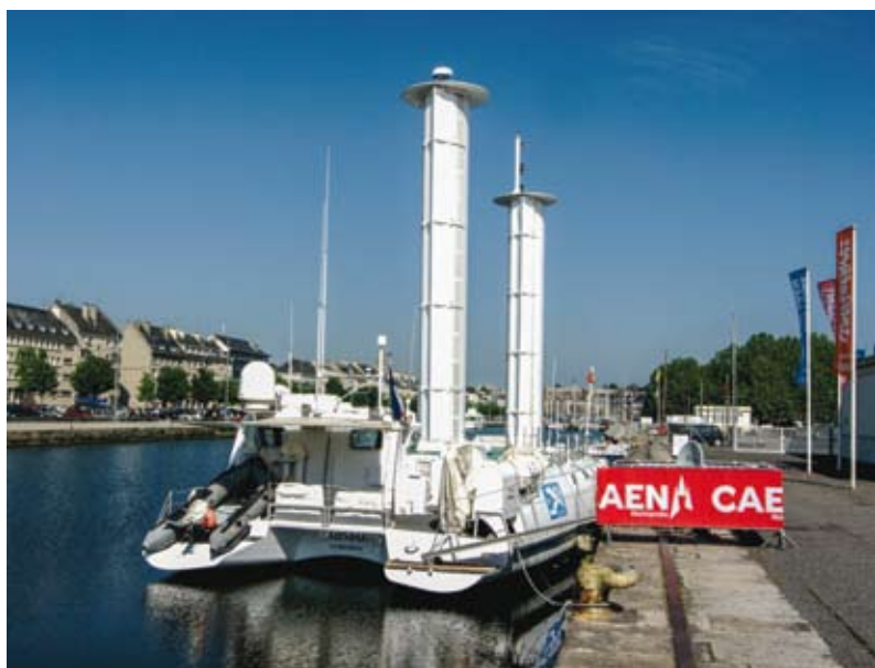
Die Alcyone besitzt zur Unterstützung des Dieselmotors einen abgewandelten Flettner-Rotor-Antrieb mit zwei Zylindern, die den Magnus-Effekt ausnutzen. Die beiden Zylinder liefern etwa 25–30 % der Antriebsenergie zur Unterstützung des Schraubenantriebs. Foto: jp hamon, CC BY-SA 3.0
