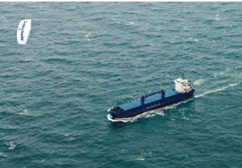
Skysail-Technik am Motorschiff „Michael A“, Foto: SkySails GmbH & Co. KG
