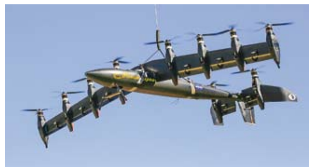
Der zehnmotorige „geölte Blitz“ der NASA: Greased Lightning GL-10.
